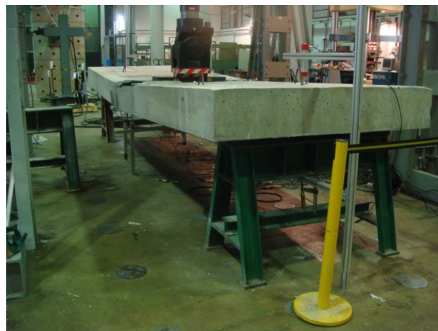
Foto 4. Estado de pre-rotura de la losa.
