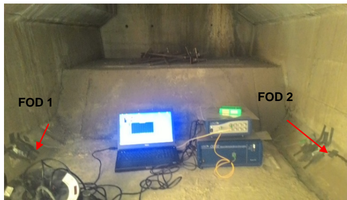
Figura 5 y 6. Carrete de fibra óptica restante sujeto a la estructura y ODiSI en funcionamiento.
