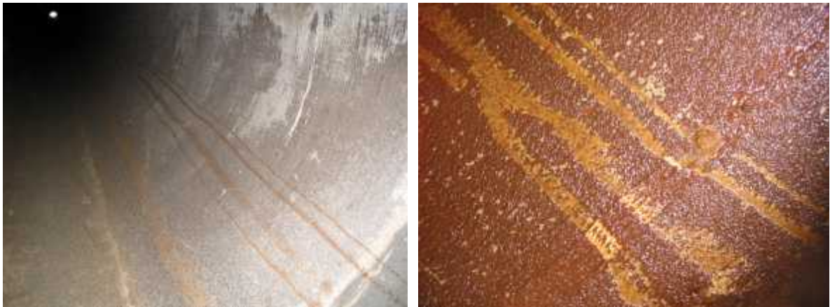
Figura 5.- Reguero de óxido según meridianos del tubo en seco y húmedo
